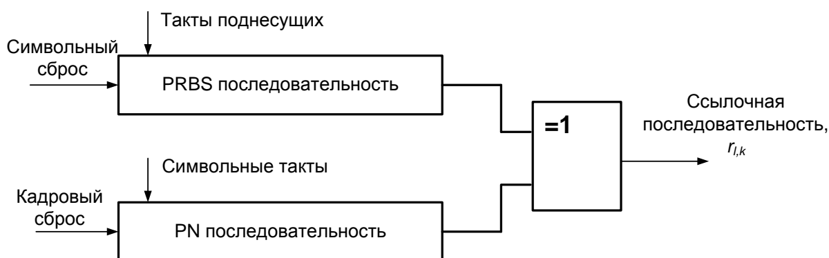
Рисунок 8 - образование ссылочной последовательности
