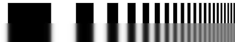
Рисунок 6 - Диаграмма пространственной частоты. Оригинал (вверху) и деградация/размытие линзы (снизу).
